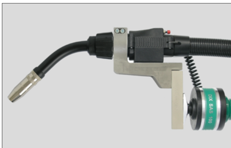
DIX PHF 100 (système complet avec système anti-collision DIX SAS 100)
