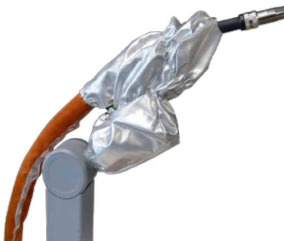
Ensemble avec housse de protection faisceau et tête de torche en tissu Texalis
