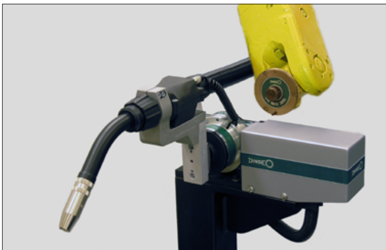
Ensemble torche sur la station désaccouplé du robot.
